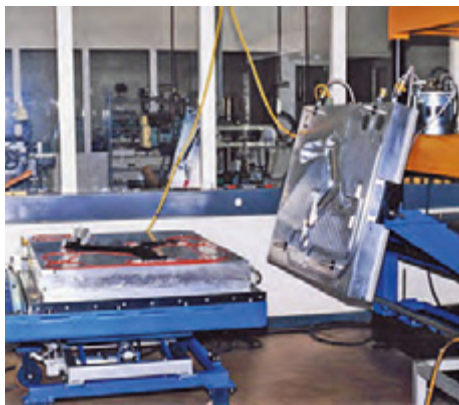
Die Rahmen werden in eine Form aus Aluminium eingebracht.
